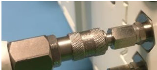
Empuje hacia el puerto, el collar avanza y se traba en su lugar
