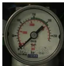
La aguja debe señalar al menos 20 bar / 290 psi (por encima de la zona roja)
